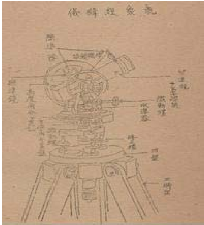
經緯儀. 摘自1930年臺灣軍司令部 氣象學參考書 第三章高層氣象觀測
