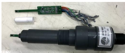
圖3：自製的溫濕度計，由上而下分別是溫濕度計電路板，溫濕度探針在電路板最左邊尖端處、多孔隙鐵氟龍外蓋、聚乙烯材質製作之外殼外觀。
