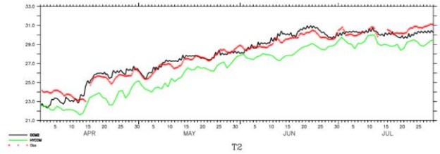
圖7 夏季案例中OCM2-NEW(黑線)、HYCOM(綠線)與新竹浮標(紅點)海溫時序資料比對
