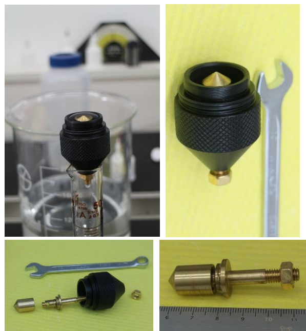
圖 4 傾斗式雨量計虹吸調節器
