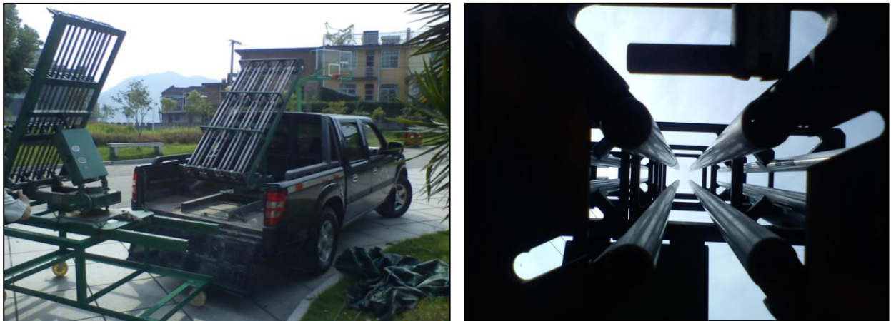
圖4 福建氣象局人工增雨火箭發射車(左)外觀(右)發射管仰視
