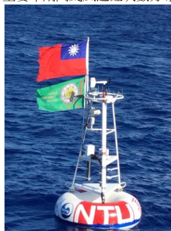
圖3 施放入海的海氣象即時傳輸浮標。
