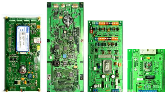
圖2 由左而右分別為海象儀器資料收集與系統資料儲存次系統、氣象資料收集次系統、氣象感應元件介面、以及銜衛星通訊數據機介面等。
