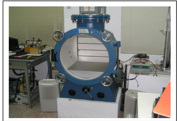
圖三 氣壓儀校正槽
