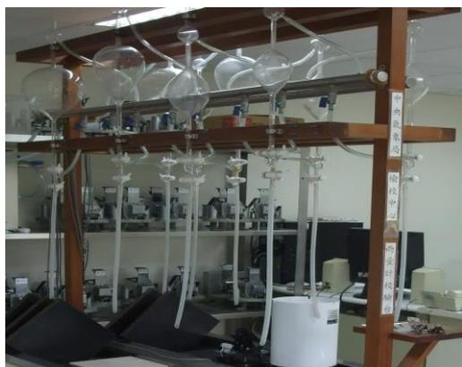
圖四 降水模擬校正設備
